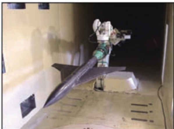
図3 JAXAの2m×2m低速風洞試験の様子
