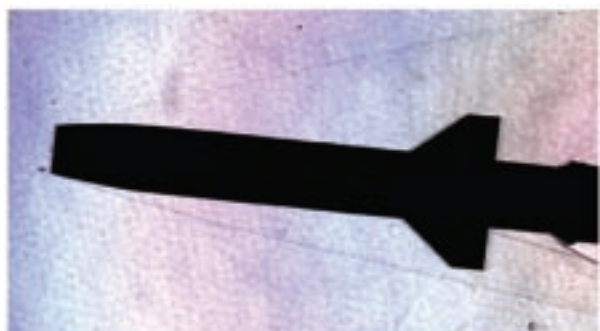
b) エンジン無, \alpha=0\text{deg} , \beta=6\text{deg}
