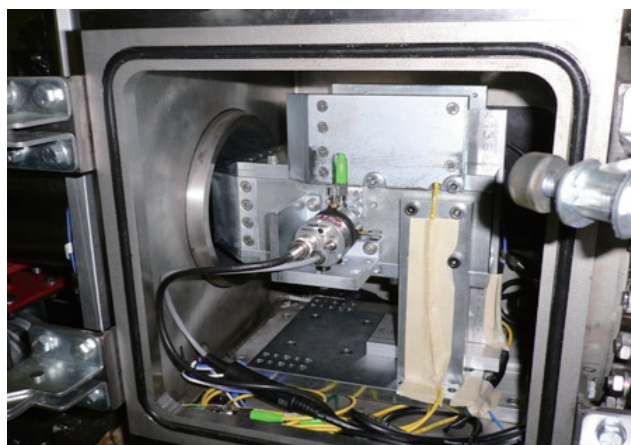
図 16 計測部に設置された温度計測用模型
