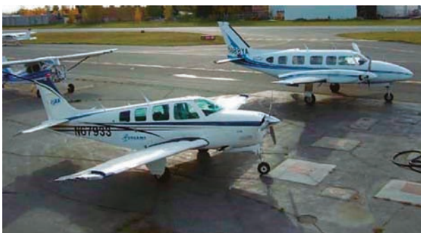
図2.3 データリンク評価実験に用いた航空機, A36(手前)とPA31(奥)
