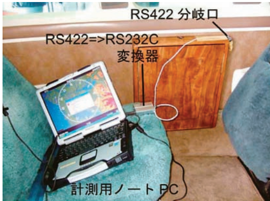
図A2.4 UATデータリンク装置のRS422データケーブルの分岐・計測
