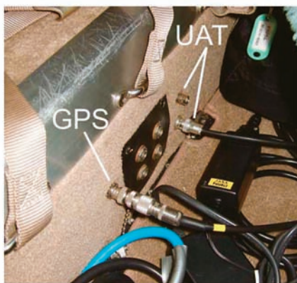
(3) UATアンテナおよび計測用GPSアンテナのキャビン内端子(キャビン後部の荷物室前部)
