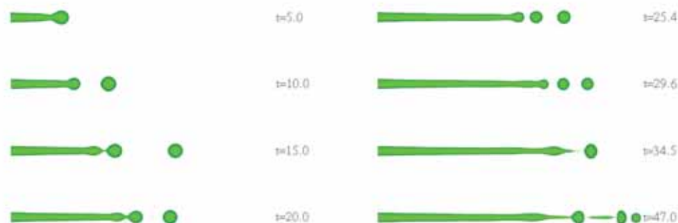
図 2 各時刻における液柱の形状
