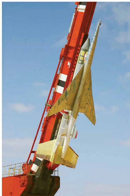
図 1 実験機写真. 飛行実験前日に撮影. 前胴および主翼表面に青く見えるのは遷移計測用センサーと静圧孔を保護するテープ。
