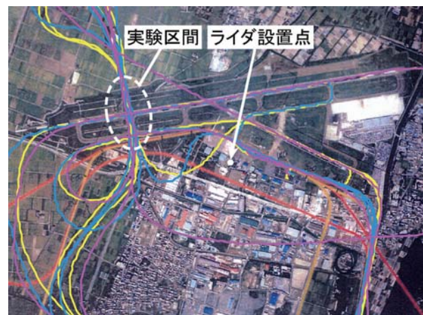
図 4.2.1 仙台空港におけるドップラー・ライダーの設置点と飛行実験における飛行軌跡
