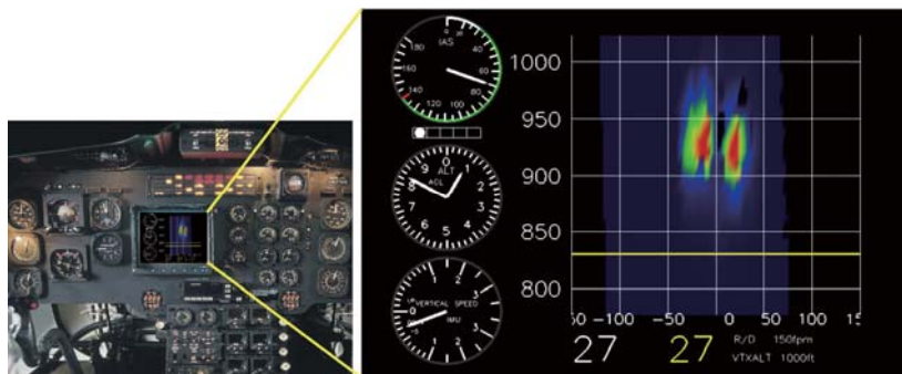
図 4.2.2 後方乱気流の情報を計器板に表示するシステム
