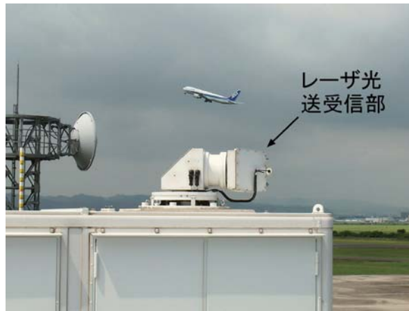
図 2.3 電子航法研究所が仙台空港に設置したドップラー・ライダー
