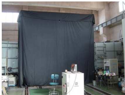
(b) 遮光用暗幕で測定部全体を覆った風洞
