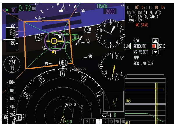
図3.2 トンネル型誘導表示
