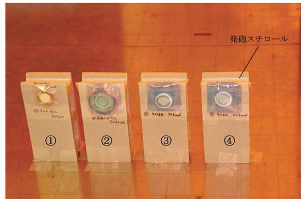
図11 被照射サンプル。放射線源はコバルト60 (1 MeV)。照射レートは20 krad/hour。サンプルは放射線源から115 cm, 高さ22.5 cmの位置に置いた。
