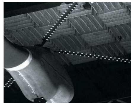
図4 ブレード上のレーザ計測用マーカ 5)
