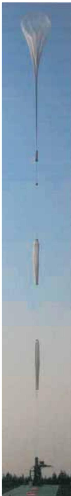
図 6 2つの試験気球を吊り下げてのタンデム方式による放球
