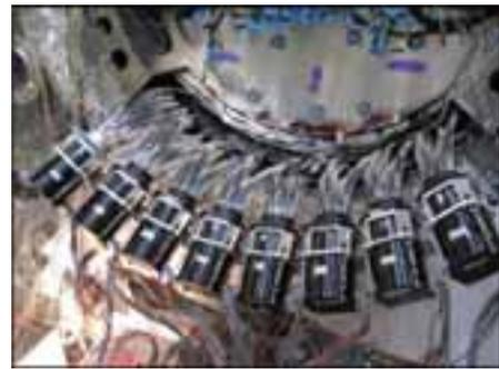
図6 MA-PMT で MTOF 信号の読出し
