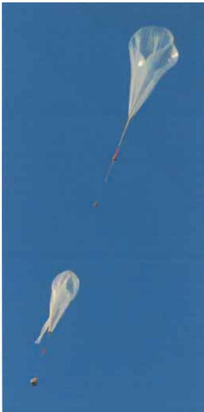
図 11 直径19m の試験気球のタンデム方式による放球，試験体は図 9 (b) と同型
