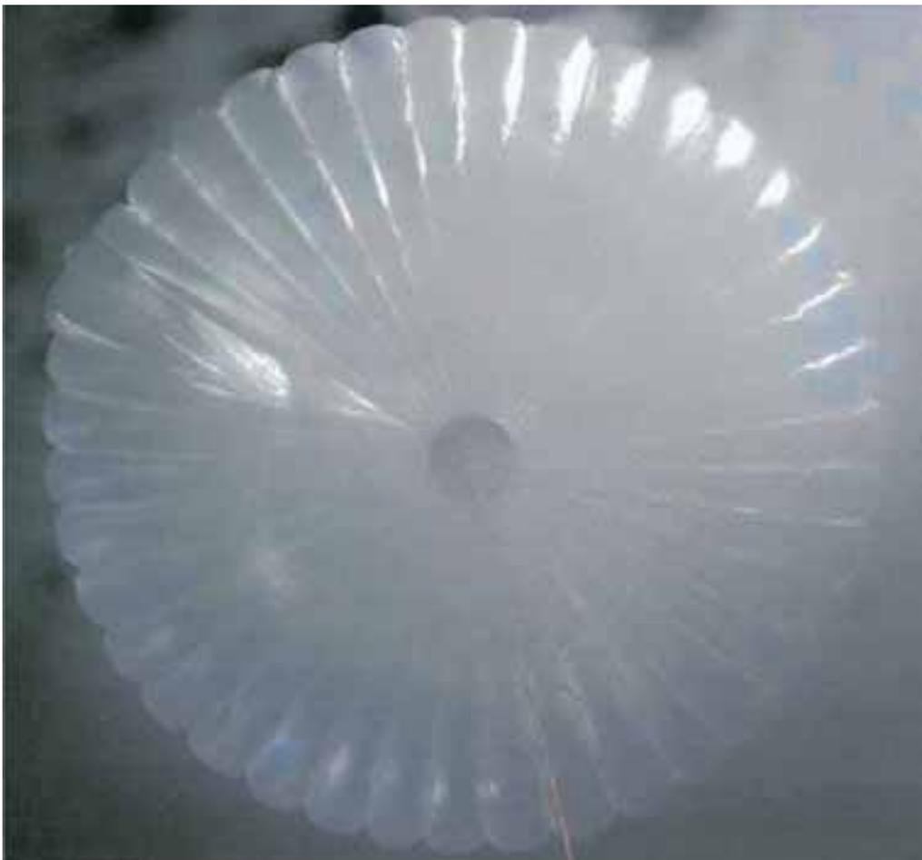
図7 試験気球（直径12m）が上空で完全に展開した様子
