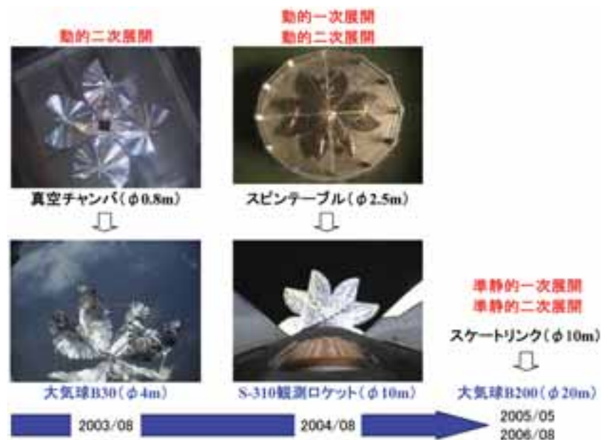
図2 クローバ型展開実験フロー
