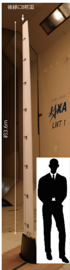
図9 荷重制御風洞試験の模型 6) 翼後縁に8枚の舵面がついていて空力荷重分布を制御します。
