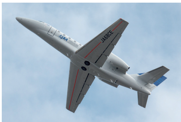
図8 主翼下面に接着した光ファイバセンサ 赤いラインに沿って接着。ファイバ自体は径が約0.2mm のため見えません。
