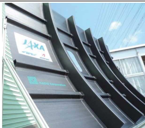
図2 低コスト製造技術による部分胴体モデル
