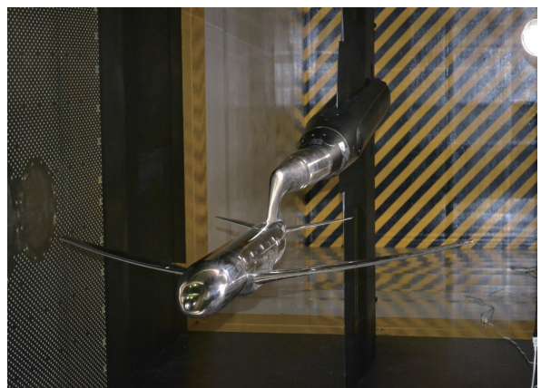
図 11 (a) 6.5m × 5.5m 低速風洞の測定部と CRM 標準模型 (左) (b) 2m × 2m 遷音速風洞の測定部と CRM 標準模型
