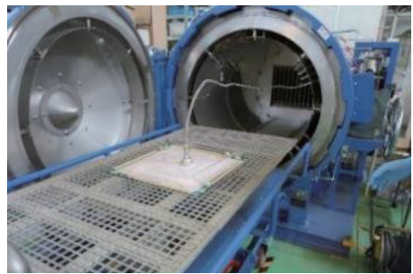
図5 リサイクル炭素繊維不織布基材（左）とオートクレーブ成形の様子（右） 8)
