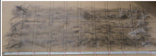
図5 リサイクル炭素繊維不織布基材（左）とオートクレーブ成形の様子（右） 8)
