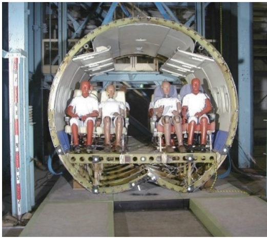
図3 小型旅客機の胴体衝撃試験（左）と解析モデル（右）
