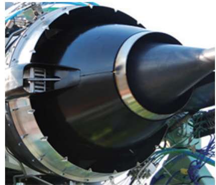
図6 ノッチノズル（上：模型試験、下：エンジン試験）
