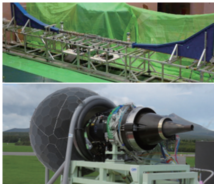
図 13 騒音試験装置 (上：フローダクト、下：小型ターボファンエンジン)
