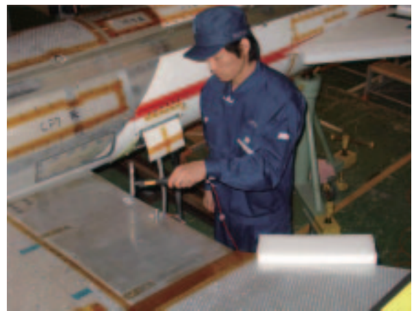
図3.2.3-5 エルロンのハンマリング試験の状況
