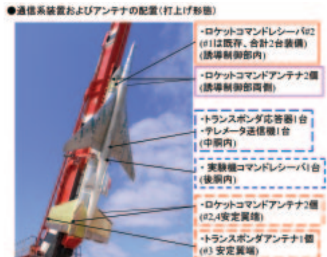
図3.3.6-1 追加アンテナと受信装置の配置(打上形態)
