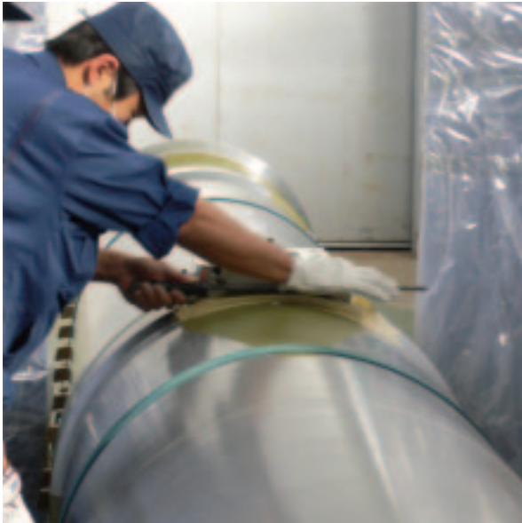
図3.4.3-4 手作業でモータケース加工の様子
