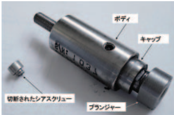
図3.2.5-21 パイロットシュート分離機構(動作後)
