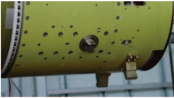
図3.3.2-3 後方スリッパ（フィン取り付け前）
