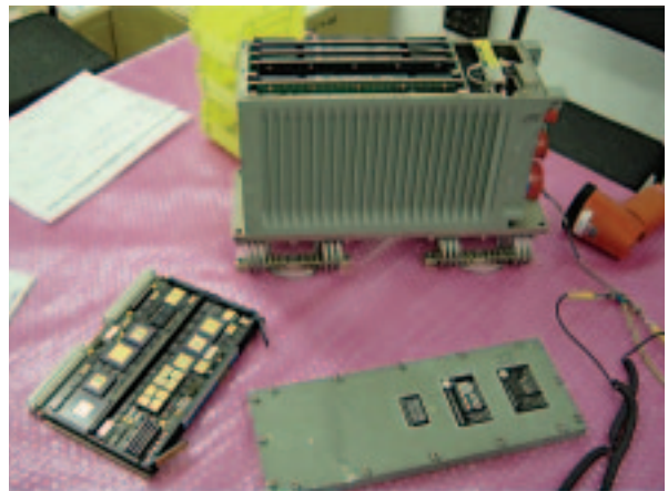
図3.2.4-3 分解確認中の飛行制御計算機
