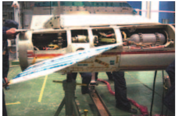
図3.2.4-2 試験中のスタビライザー胴体内にアクチュエータなどラダーの駆動系統が装備されているのが見える
