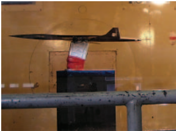
図3.2.5-31 パイロットシュート風洞試験
