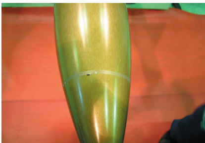
図4(a) テープラフネス (直線貼)
