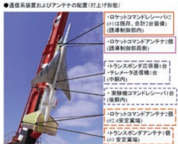
図3-2 通信系装置とアンテナの配置 (打上げ形態)
