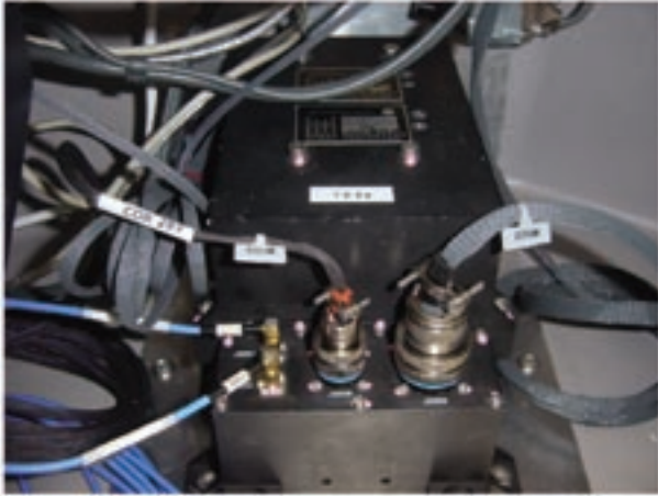
図A.2-2 非常指令受信装置の実装外観
