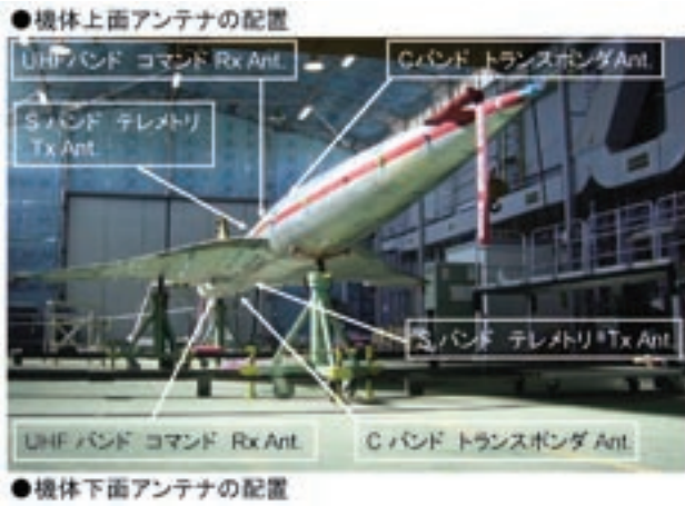
図3-1 実験機アンテナの配置
