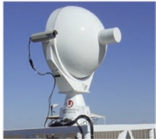
図3-8 ITVカメラの取り付け外観 (ANT1)
