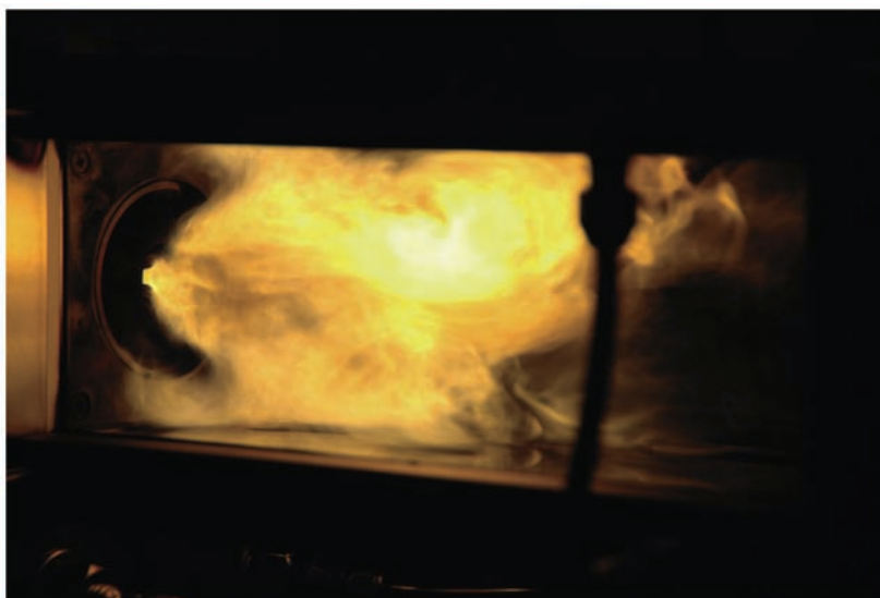
図5-18 火炎写真 (燃料ノズルP2+S3+M3+E2)
