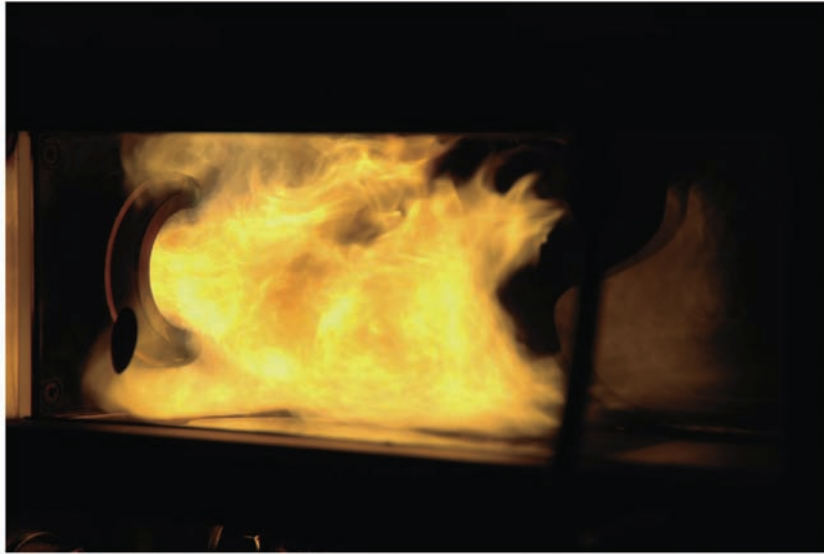
図5-19 火炎写真（燃料ノズルP2+S3+M3+E3）
