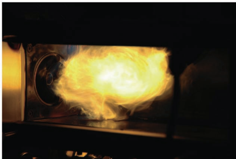
図5-21 火炎写真（燃料ノズルP4+S2+M3+E2）
