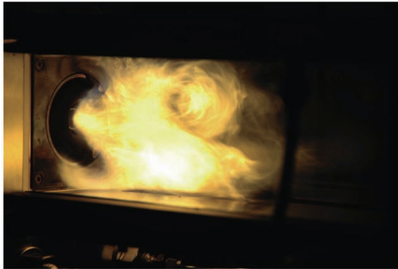
図5-20 火炎写真（燃料ノズルP4+S1+M3+E2）
