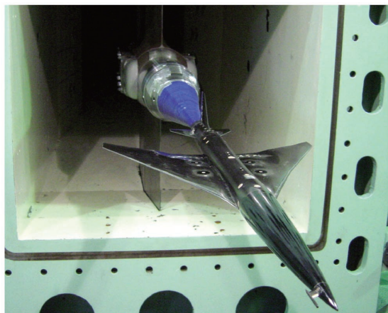
(a) JAXA 1m×1m 超音速風洞試験 (8.5%模型)
