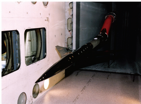
(b) ONERA-S2MA 風洞試験 (23.3%模型)
