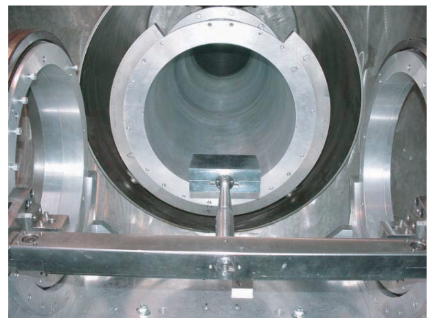
図6 模型後方の支持装置の梁の状況
