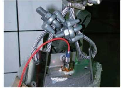
図4.1.2-4 加速度計の取付け
