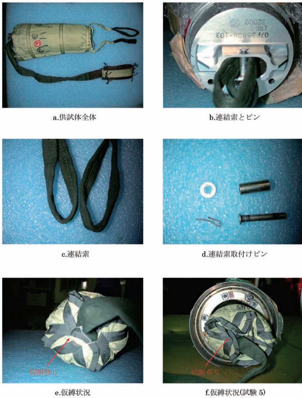
図4.1.2-8 試験後の供試体損傷状況（試験6）
