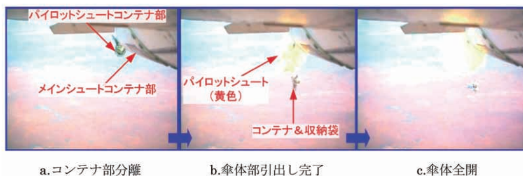
図5-1 パイロットシュート部開傘シーケンス（飛行実験）
