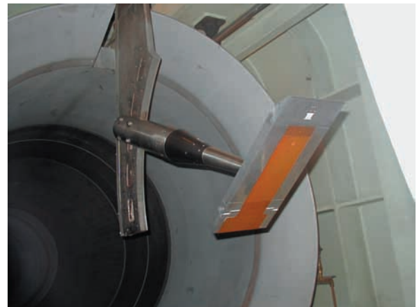
図 3-7 高速模型投入装置に取り付けた模型
