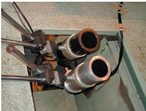
図 3-5 赤外線カメラ取り付け状況
