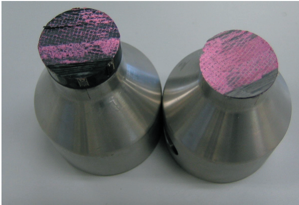
Fig.16 t8mm 直径 25mm 供試体の破断面
