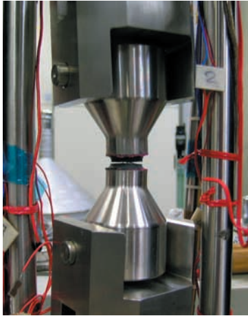
Fig.19 t8mm 最小断面部直径 18.75mm 供試体の試験後状況
