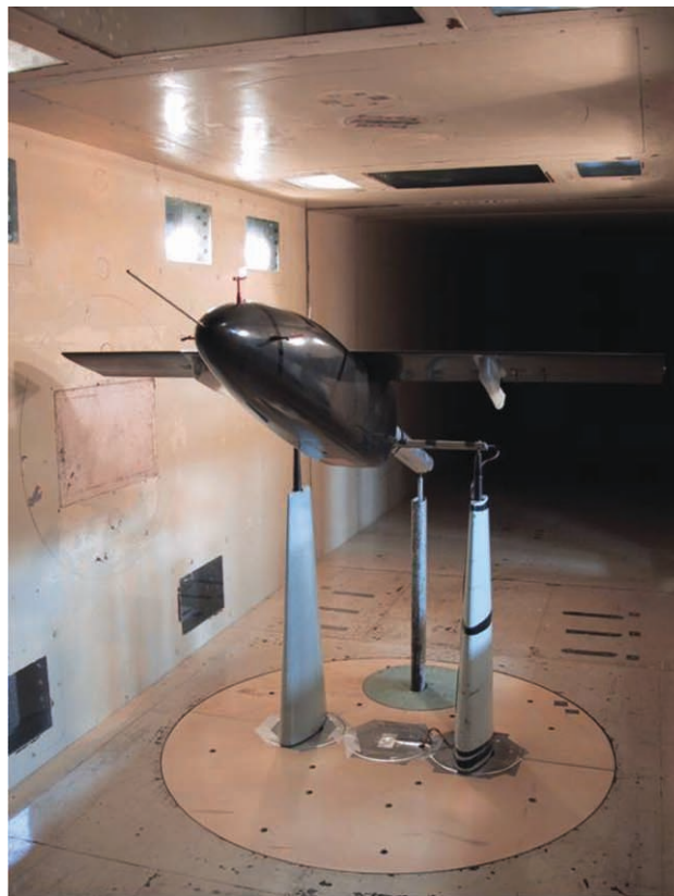
(a) 2m 低速風洞試験（エアデータシステム校正試験）
