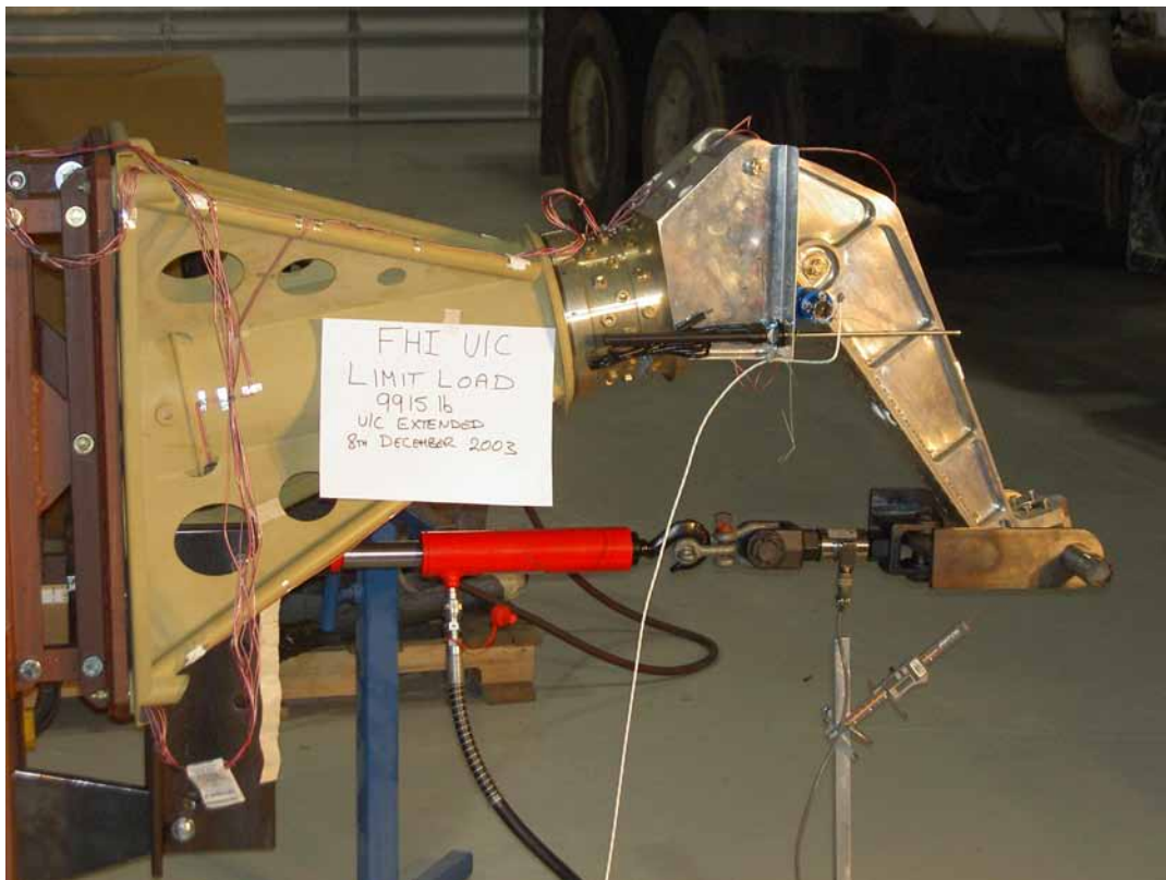
図 4.11.1-7 静強度試験の状況
