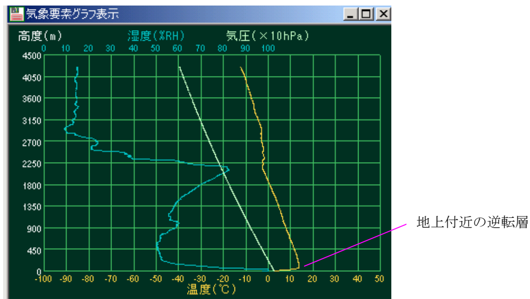
図 4.17-25 2004/10/30 4時のゾンデ観測による気温湿度プロファイル
