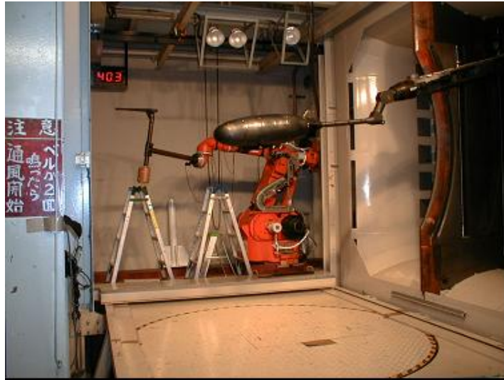
図 2.5.2-3 風洞測定部で後方スティング支持された模型の写真
