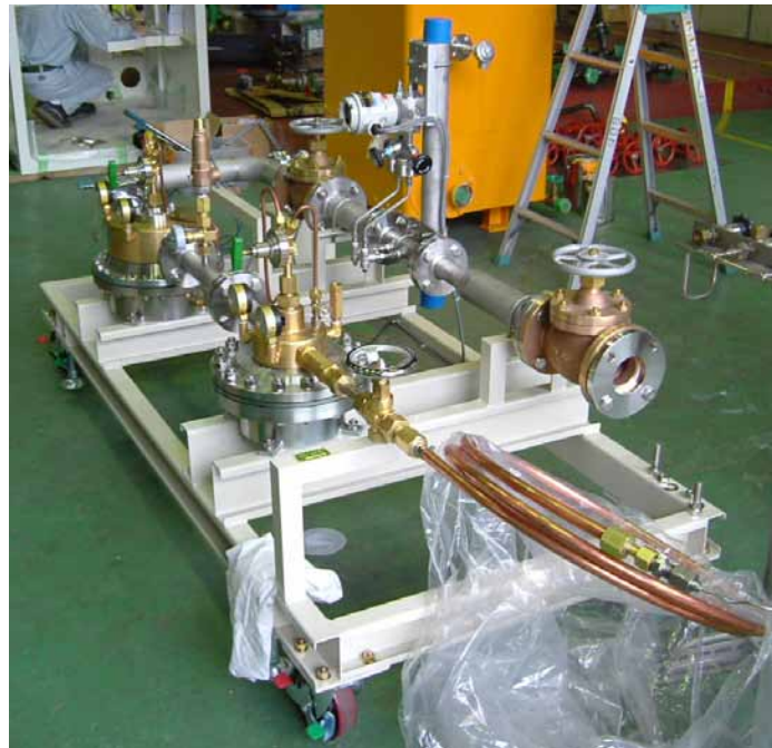
図 2.2.14-4 ヘリウム充填装置外観
