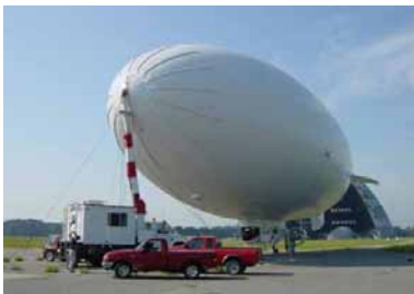
(全長60m有人飛行船Skyship 600BLを使用)
