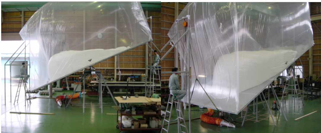
図 2.5.4-4 空気試験状況(水 40%、ピッチ角 20^\circ )
