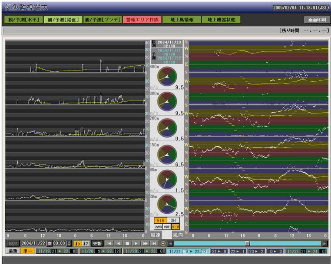
図 4.17-27 予測システムによる風予測とソーダーの実測値の比較
