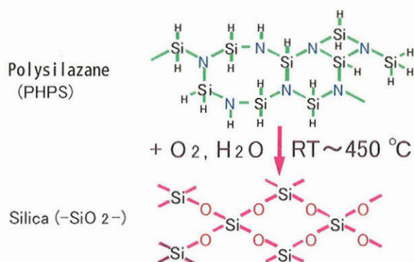
図 4-16 シリカ前駆体ポリマー (PHPS) からシリカへの転化プロセス
