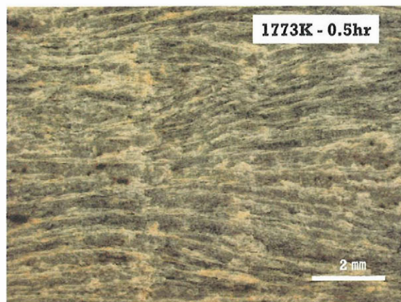
(b)加熱試験後のシリカ膜表面の拡大
