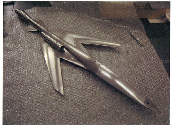
付図 3-1 前進翼形態の風洞試験模型
