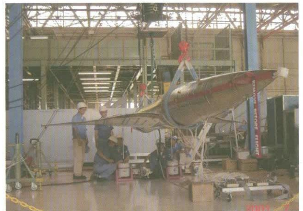
図3.4-14 振動試験のセットアップ
