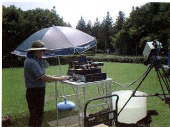
図 11 野外における濁水光学観測の状況
