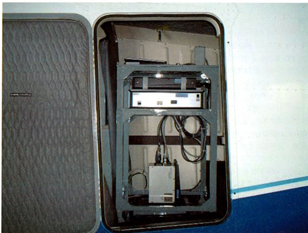
図 31 ドルニエ Do-228 に装着された LCTF センサ観測システム
