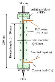
Fig. 1. Test heater
