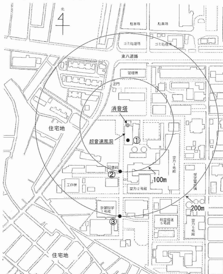
図 31 風洞騒音測定場所 (①~③)
