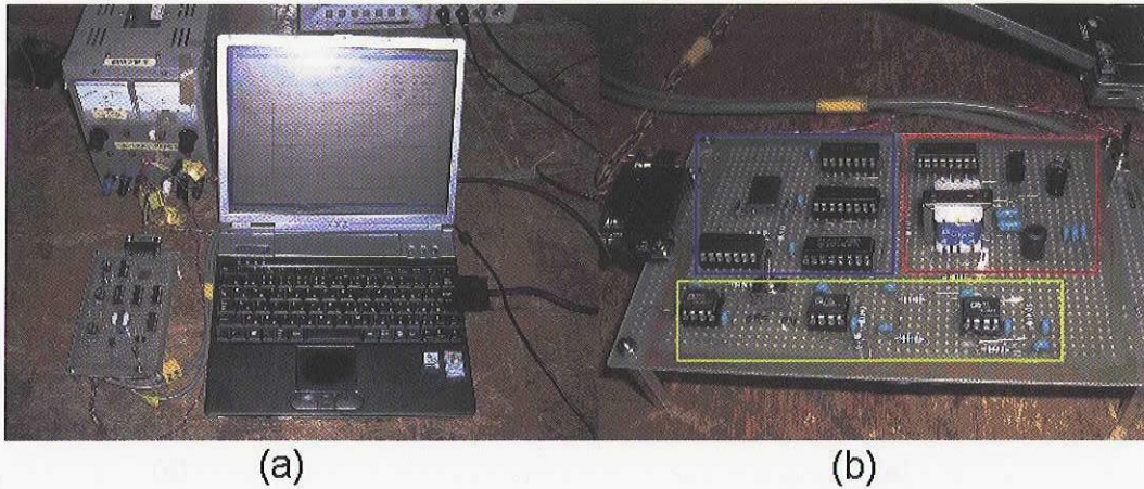
図 3.3 I/O ボード, PC を用いたデジタル方式フラックスゲート磁力計. (a) 左下はアナログ回路部を配置したユニバーサル基盤, 中央はデジタル信号処理部の PC. (b) アナログ回路部を拡大したもの. 色囲はそれぞれクロック回路 (青囲), ドライブ回路 (赤囲), ピックアップ信号処理回路+フィードバック回路 (黄囲) である.
