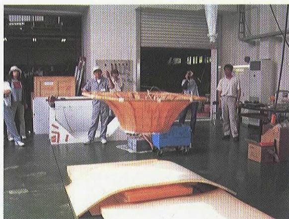
図9 フライトモデル切り離し試験で落下中の機体
