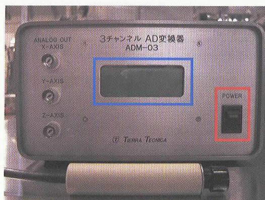
図37 磁力計（コントローラー部）と磁場データ取得スイッチ
