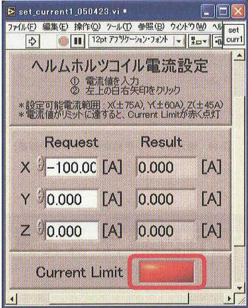
図45 電流値設定（エラー発生時）
