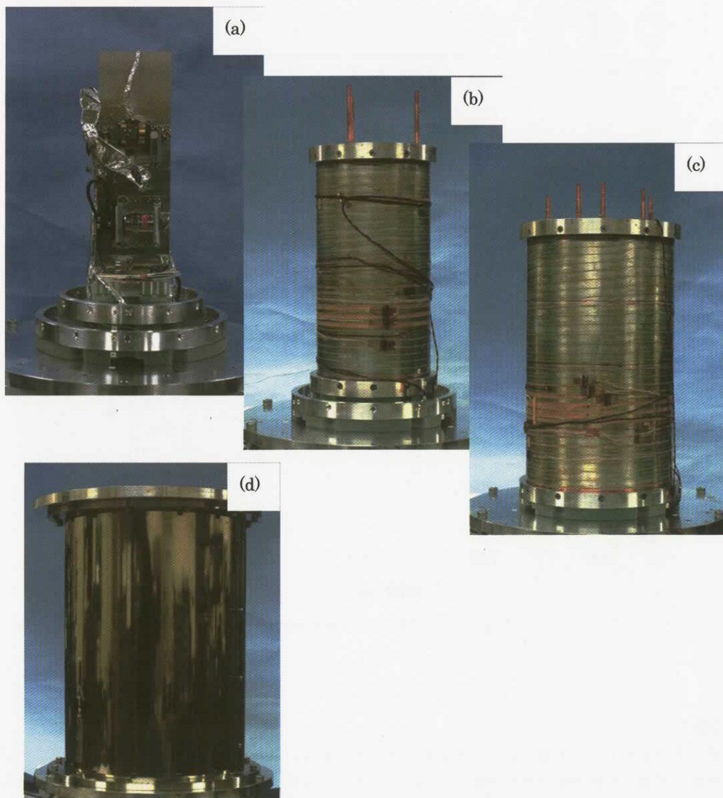
図6.3-7 熱シールドの構成。(a) 内蔵する光学系、(b) 第1熱シールド、(c) 第2熱シールド、(d) アウトージャケット
