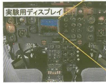
図 1.3 地上騒音計測飛行実験で用いたコックピット・ディスプレイ (文献 6 より引用)
