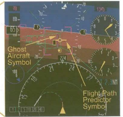
図 1.3 地上騒音計測飛行実験で用いたコックピット・ディスプレイ (文献 6 より引用)
