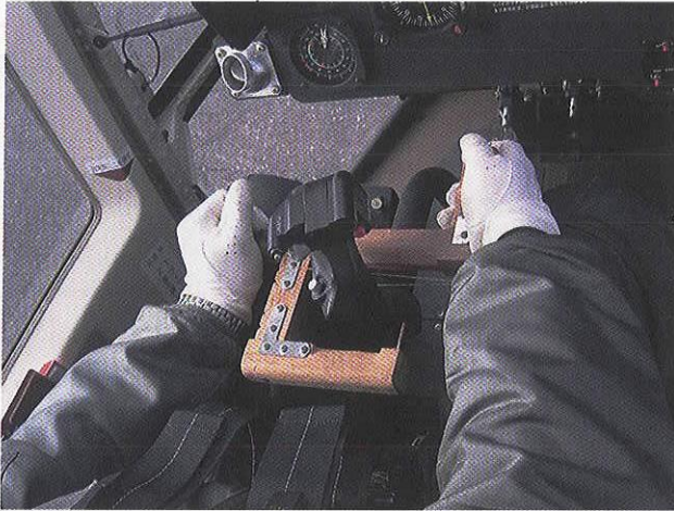
図 2.5.3 操舵入力振幅を定める治具
