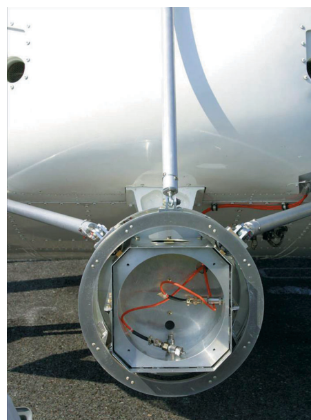
図3.5 振動計測用ダミーへの加速度計の取付状況
