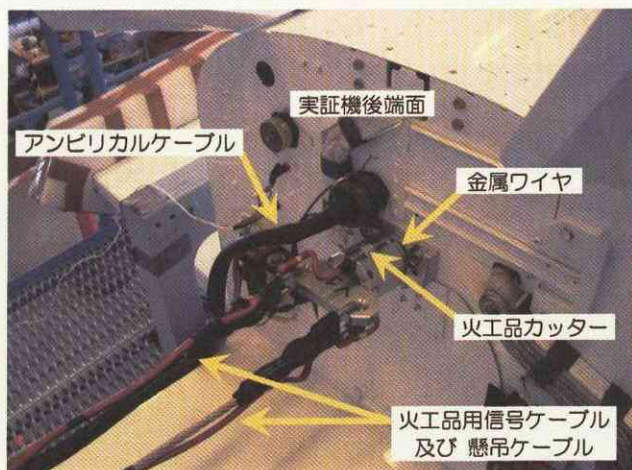
図 3.1-30 実証機分離機構
