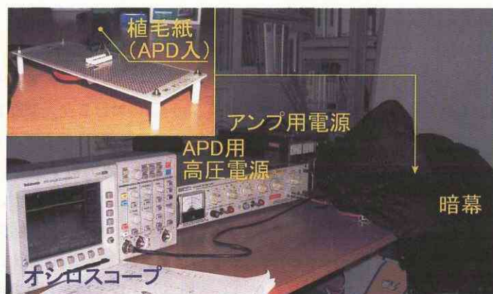
図3.14. APD暗電流—逆電圧特性実験風景.
