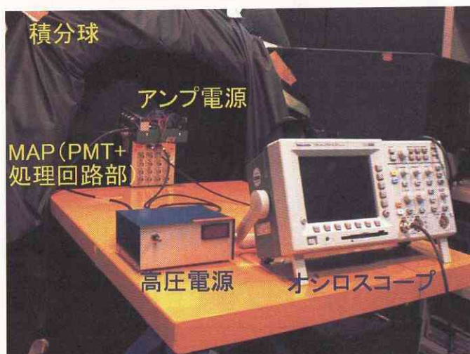
図3.7. PMT出力電圧測定実験風景.
