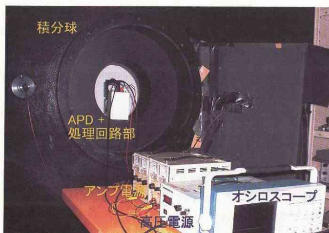
図3.11. APD出力電圧測定実験風景.
