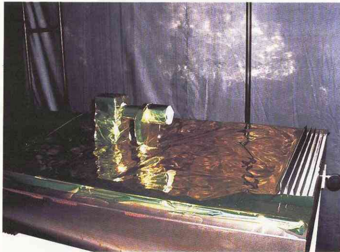
図4.11. LAC模型写真。金色のサーマルブランケット表面素材で覆われている。
