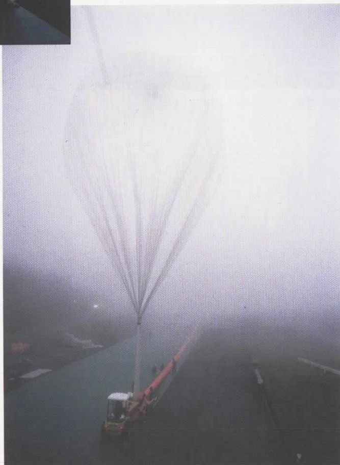
図7 ウインチロープの繰り出しによる気球頭部の立て上げ
