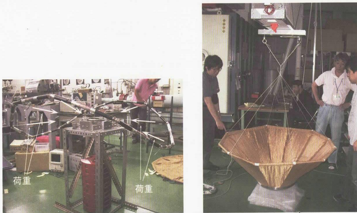
図7 強度試験の様子、(左) 外枠の圧縮荷重試験 (荷重100kgf)、(右) ゴンドラからの吊り下げ試験
