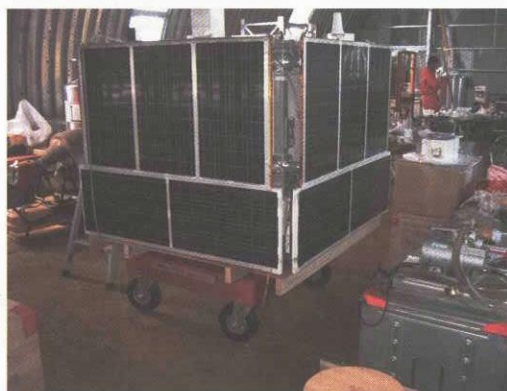
図5 PPB7号機太陽電池パネル装着後
