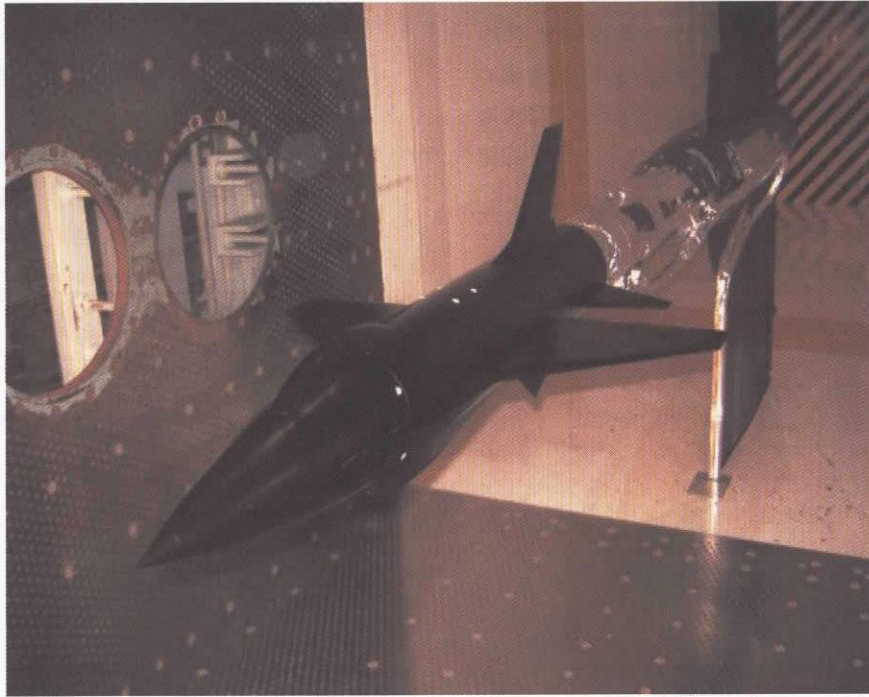
写真3 動的標準模型の測定部セットアップ写真
