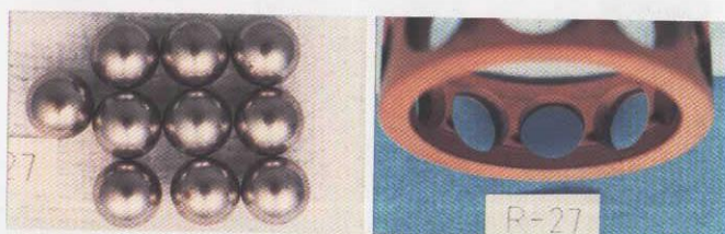
図4-26 試験後の軸受外観（PEPE-D油含浸保持器の軸受） (d)リア側玉，保持器
