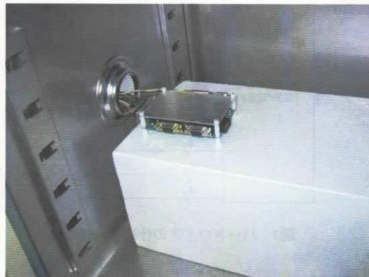
図9 熱環境試験のセットアップ。(左) 恒温槽とモニター。(右) 恒温槽内に置いたコマンドデコーダ。
