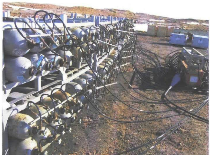
図8 ヘリウムガスボンベの接続
