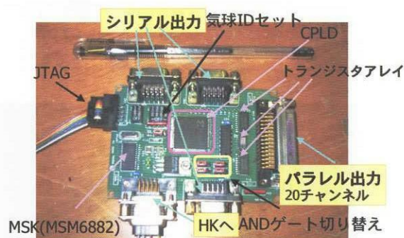
図8 作成したコマンドデコーダ(試作品2)
